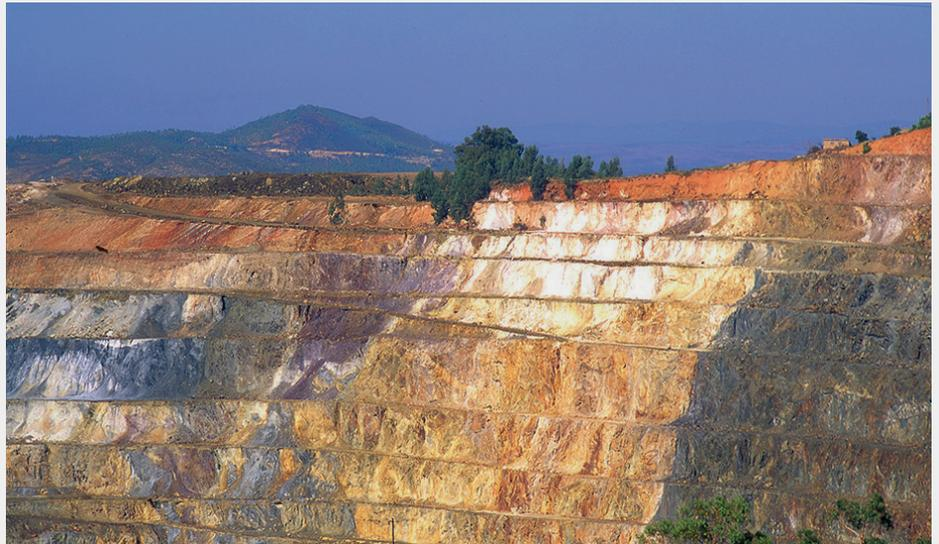
**Corta Atalaya, ein Tagebau der Riotinto Minen, Massivsulfide in dunkel (Bild)**
